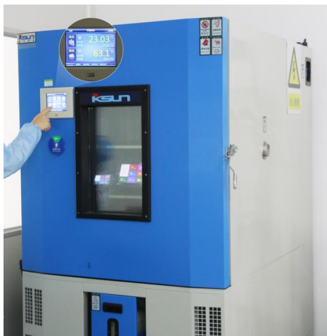
图 5-3 高低温老化测试图
